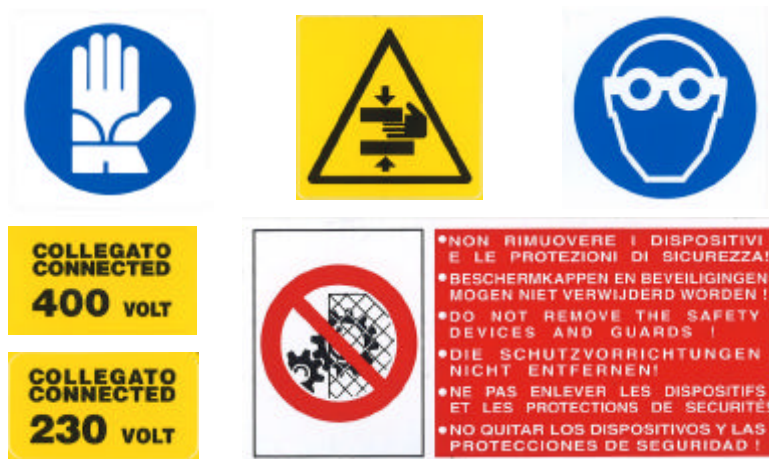
Figura 4: Esempi di possibili segnali di pericolo affissi sulla macchina
