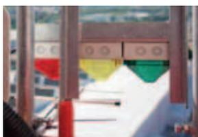
5.3 Les grues télécommandées doivent être fournies avec des indicateurs lumineux extérieurs indiquant l'état de la machine. L'indicateur vert doit être placé de façon à être visible par les personnes se trouvant près de la grue.
