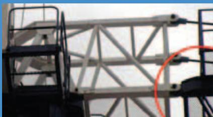
La largeur des vides sur les passerelles doit toujours être inférieure à 200 mm. Sur cette photo, le vide peut être dangereux pour l'opérateur.
