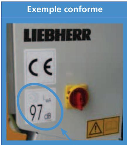
Le niveau acoustique est imprimé par décalquage. Le niveau de puissance acoustique est généralement situé au pied de la grue et dans sa partie supérieure.
